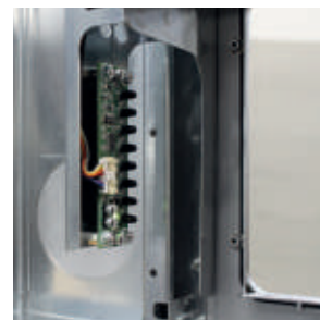
Fotocellule riconoscimento bicchieri fino a 3 altezze diverse
